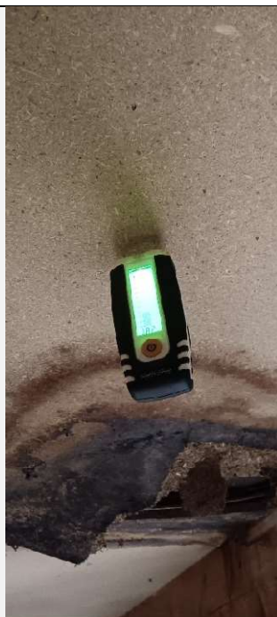
Photo 25 – La fuite a due être réparée car le taux d'humidité est à 18% mais est au-dessus de la moyenne sur cette charpente.
